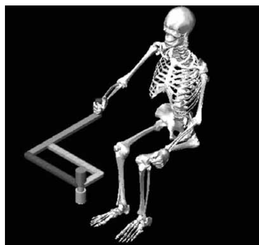
Figura III.2. Interfaccia grafica del simulatore biomeccanico ADAMS/LifeMOD che modella il sistema robotico InMotion 2 interagente con un soggetto umano.
